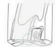
(圖7)內刃靠近鑽頭中心時崩損
